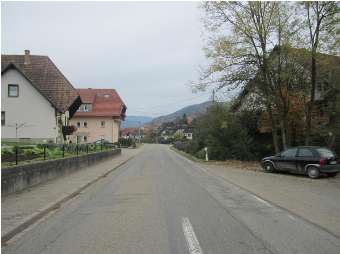
Abbildung 8: Überbreiter Straßenraum führt zu hohen Geschwindigkeiten
